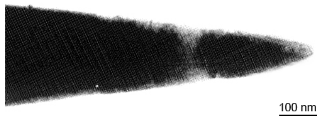
Abbildung 2.4: TEM Aufnahme einer Probenspitze, die für die dreidimensionale Atomsonde geeignet ist.
