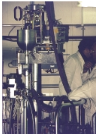
Antrieb für Rotation und Vertikal- bewegung des Probenträgers am Kopf der DBVK
