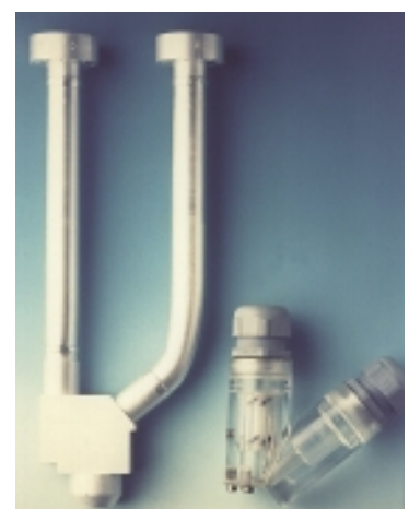
Bestrahlungsstation (Rechts: Modell für Testzwecke). Die Probenkapsel wird während der Bestrahlung zum Ausgleich zum örtlichen Flußunterschieden in einem kontinuierlichen Gasstrom gedreht.
