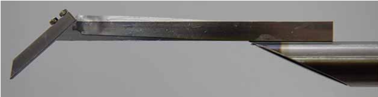
Abbildung 2b: Vergleich der beiden eingebauten Spiegelhalterungen: Komplet – ohne und Reste der Halterung – nach Bestrahlung durch Synchrotronstrahlung
