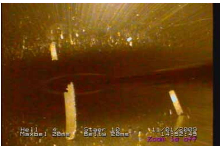
Abbildung 3: Am Sonntag mit dem Endoskop in der ID-Kammer gefundene Fetzen, Flocken und Krümel – die Reste des verdampften Spiegels. Erkennbar ist der elliptische Querschnitt der Kammer mit der schmalen Verbindung zur direkt gepumpten Vorkammer.
