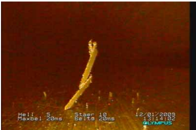
Abbildung 5: Konglomerat aus übereinander stehenden Spänen, das dann mehrere mm in die Kammer ragt - die Situation nach mehrmaligem Säubern der Kammer!
