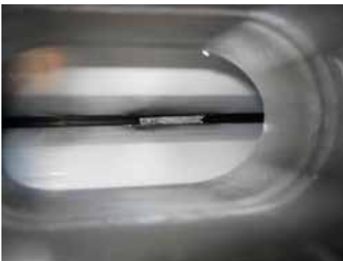
Abbildung 2a: Blick durch den Pumpstutzen – im schmalen Schlitz zwischen der Pumpkammer und der flachen Kammer des U-139 ist der verklemmte Spiegel zu erkennen.
