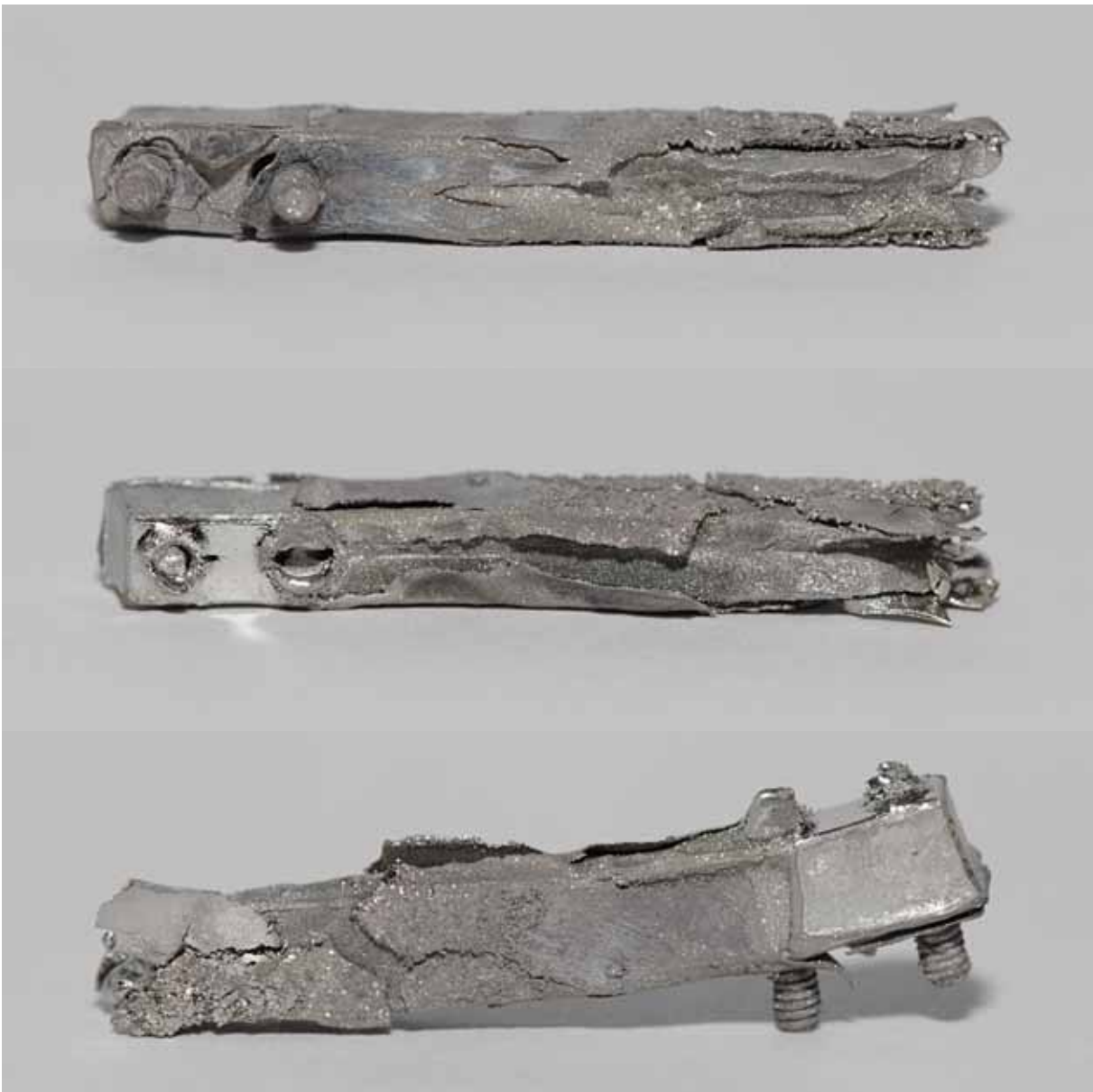
Abbildung 2b: Vergleich der beiden eingebauten Spiegelhalterungen: Komplet – ohne und Reste der Halterung – nach Bestrahlung durch Synchrotronstrahlung
