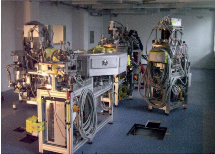
Die neue Clusteranlage des PVcomB ist mittlerweile in Betrieb. HZB-Wissenschaftlern gelang es mit dieser Forschungslinie, die ersten größeren Photovoltaik-Module herzustellen.
