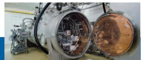
des Niob eingesetzt werden, mit dem eine Tausend Mal höhere Leistung erzielt werden kann. Doch dafür müssen die Niobkavitäten auf Temperaturen von zwei Kelvin (-271,15 Grad Celsius) gekühlt und zusätzlich vor äußerer Wärmezufuhr geschützt werden. HoBiCaT ist ein wichtiger Bestandteil des Zukunftsprojekts BERLinPro. Auch die neue Elektronenquelle des ERL-Beschleunigers, ein Photoinjektor, basiert auf einer supraleitenden Kavität. Der erste Prototyp wird 2011 in der HoBiCaT in Betrieb genommen.
