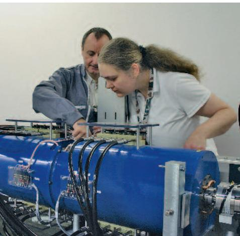
Der neue Injektor mit verbesserten Strahleigenschaften wurde in den Elektronenspeicherring eingebaut.
