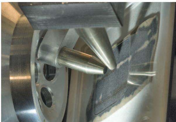
Bei der Untersuchung eines Schriftrollen-Fragments an der Synchrotronstrahlungsquelle BESSY II werden Pergament und Tusche analysiert.
