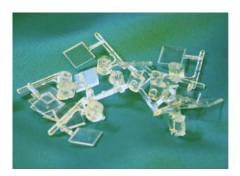
Diffraktive optische Elemente (DOE) erlauben die kontrollierte Manipulation von Laserlicht durch gezielte Beugung an mikro- und nanostrukturierten Oberflächen und ermöglichen eine nahezu beliebige Formung des Lichtes. Dadurch lassen sich völlig neuartige optische Funktionen verwirklichen, die bislang durch klassische optische Komponenten nicht realisiert werden können.
