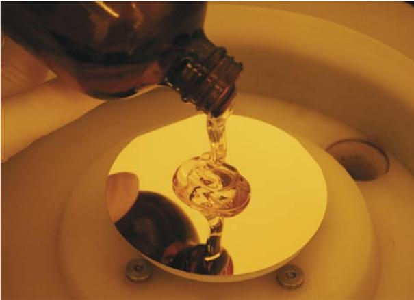
Die Basiskomponente zur Herstellung von Strukturen in der Mikro- und Nanotechnologie sind Photoresiste. Diese werden über lithographische Schritte strukturiert und dienen der Maskierung von Substraten. Sie werden bei einer Vielzahl von Prozessen in der Mikrotechnik und Halbleiterindustrie eingesetzt.
