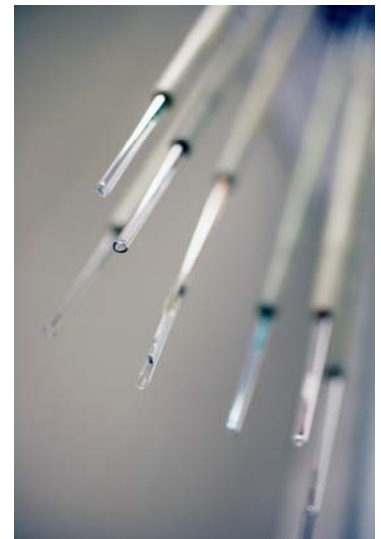
Spezielle Probenhalterungen für die EPR-Messung
