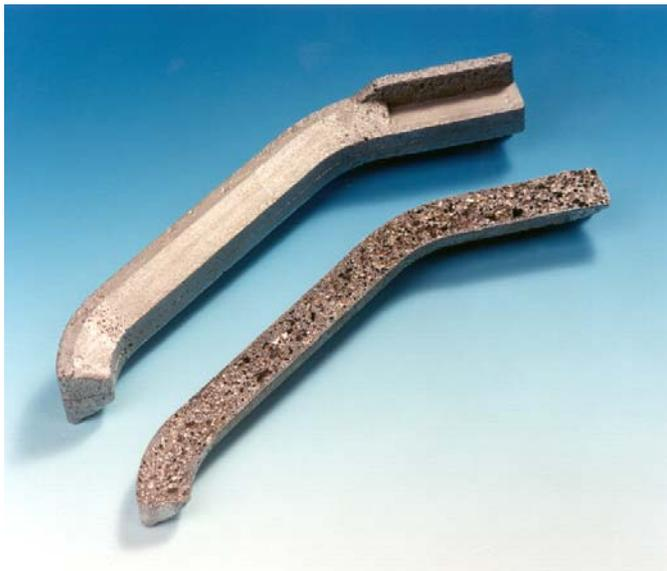
**Figure 2:** Aluminium foam part (Schunk Sintermetalltechnik, Giessen)
