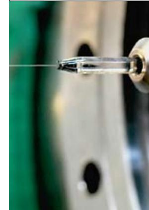
**EIN MIKROJET**, also ein ganz dünner Wasserstrahl, ermöglicht den Forschern die Messung wässriger Proben.
