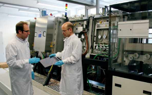
Mitarbeiter prüfen eine neue Beschichtung an der Sputteranlage des PVcomB.
