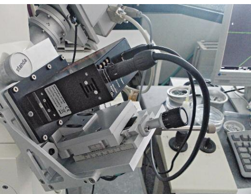
Das wellenlängendispersive Spektrometer (li.) wird an ein Rasterelektronenmikroskop (Zeiss- EVO 40) angeschlossen.
