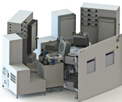
Ein Cluster-Tool zur Erforschung neuer Materialien und Bauteilstrukturen für Photovoltaik- und Photokatalyse-Anwendungen.
