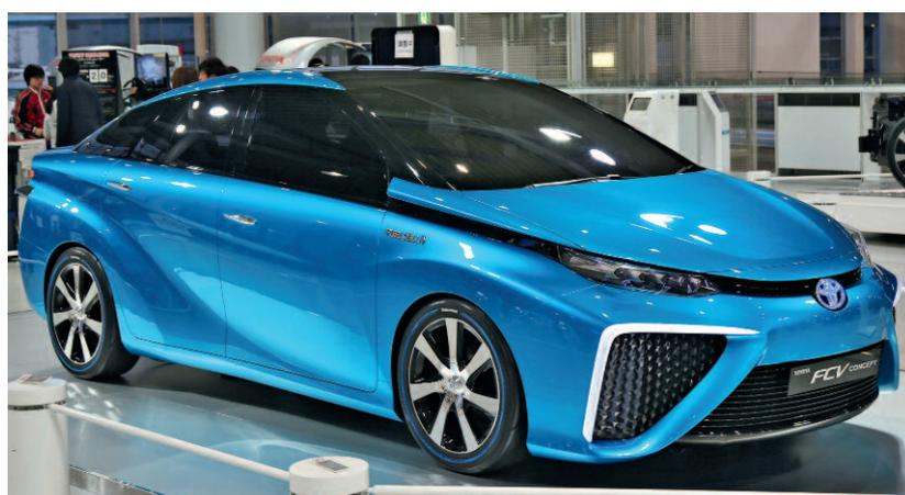
Fahrzeuge mit Brennstoffzellen wie der Toyota Mirai, die mit Wasserstoff betankt werden, benötigen für die „kalte“ Verbrennung von Wasserstoff und Sauerstoff aus der Luft hochaktive Katalysatoren, für die bislang das sehr teure Platin verwendet wird. Dank der am HZB und der TU Darmstadt erzielten Forschungsergebnisse könnten für solche Katalysatoren künftig deutlich günstigere Materialien eingesetzt werden, die ähnlich effizient arbeiten.
