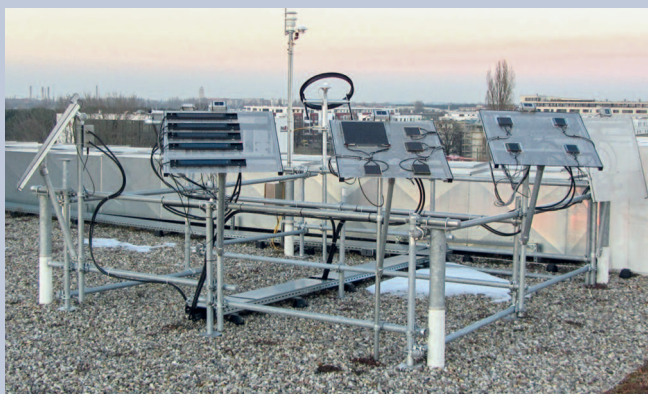
Auf dem Freifeld-Teststand des PVcomB werden die Erträge von CIGS-Modulen unter realen Bedingungen erfasst.
