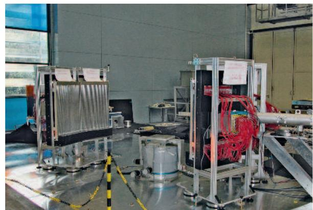
Am Ende des Neutronenleiters (rechts) stehen je zwei Detektoren für die Vorwärts- und Rückwärtsstreuung. Im Zentrum des Instrumentes (Mitte) befindet sich ein Instrumententisch für Testmessungen. Dort wird später das wesentlich größere Magnetsystem stehen. Zusätzlich (nicht im Bild) gibt es verschiedene Choppersysteme im Verlauf des Neutronenleiters sowie Computersysteme zur Steuerung der Choppersysteme und zur Auswertung der Detektordaten.
