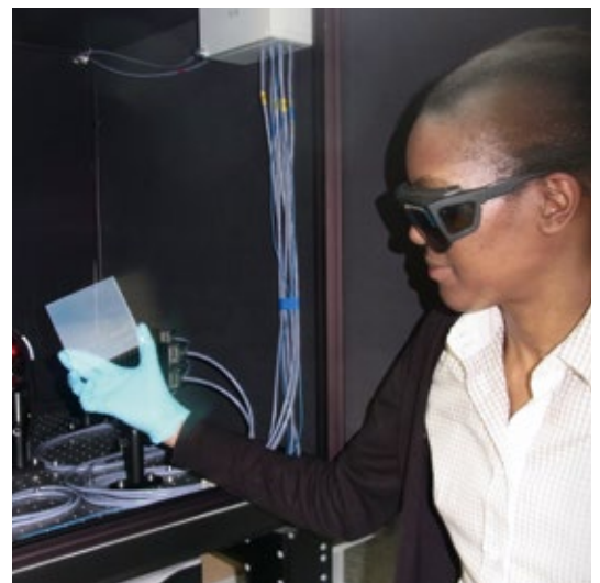
Ein Forschungsschwerpunkt von Sonya Calnan sind transparente Kontakte aus Zinnoxid oder Zinkoxid, die mehr Licht in die Silizium-Dünnschicht-Solarzellen durchlassen. Hier zeigt sie Proben mit unterschiedlicher Oberflächenrauigkeit. Foto: A. Rötger / HZB
