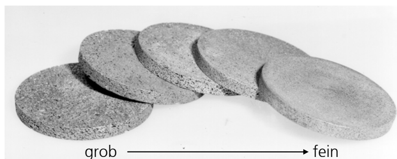
Abbildung 4: Offenporige Aluminiumschäume mit verschiedenen Porenfeinheiten. Durchmesser der gezeigten Scheiben: 100 mm, Dicke: 10 mm
