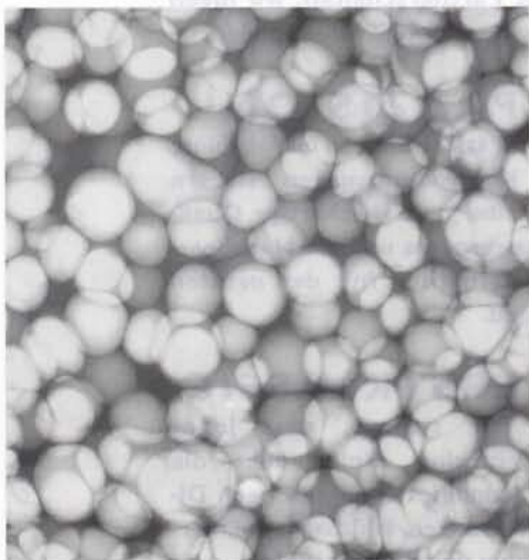
Röntgenbild eines Metallschaums (Foto: HMI)
