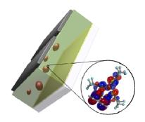
Schema eines organischen elektronischen Bauteils mit Dotier-Molekülen (braune Einschlüsse) im aktiven Film (grün). Rechts die Vergrößerung eines molekularen Ladungstransfer-Komplexes und eines Hybrid-Orbitals.
