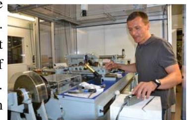
In diesem Gerät entstehen die Sägezahn-Strukturen. Ein Diamant ritzt dabei in die mit Gold beschichteten Silizium-Substrate kleinste Rillen.
