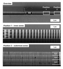
Unter dem Rasterelektronenmikroskop wird sichtbar, wie genau die drei Fresnel-Zonenplatten übereinander positioniert werden konnten. Mit solchen 3D-Röntgenoptiken lassen sich Auflösung und Lichtstärke deutlich steigern. Bild: S. Werner/HZB
