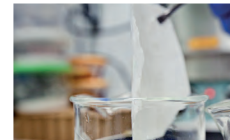
Das Material besteht aus Nafion mit eingebetteten Nanopartikeln. © B.Matos/IPEN
