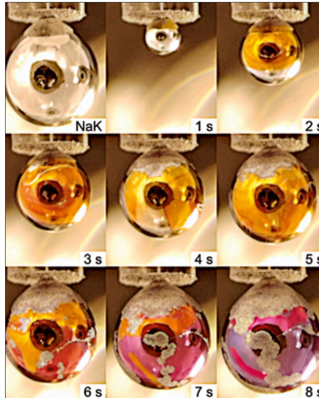
Nach etwa fünf Sekunden hat sich ein dünner Film aus metallischem Wasser um den Natrium-Kalium-Tropfen gebildet, erkennbar am goldenen Schimmer. © HZB
