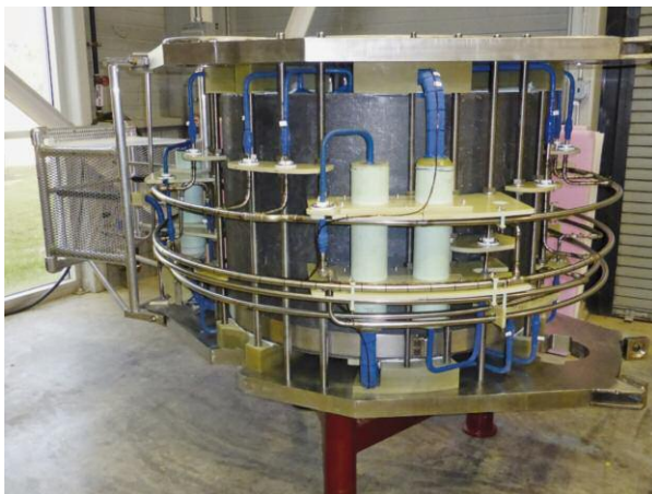
Ein Meilenstein ist nach fünfjähriger Entwicklungsarbeit erreicht: So sieht die supraleitende Spule des neuen Hochfeldmagneten aus.
