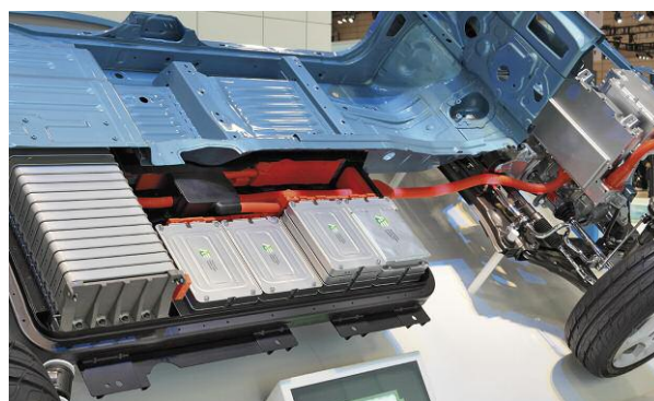
Noch verwenden Automobilhersteller in Elektrofahrzeugen wie diesem Nissan Leaf Lithium-Ionen-Batterien, doch die Forschung nach besseren Alternativen läuft – nicht zuletzt durch Experimente am HZB – auf Hochtouren.
