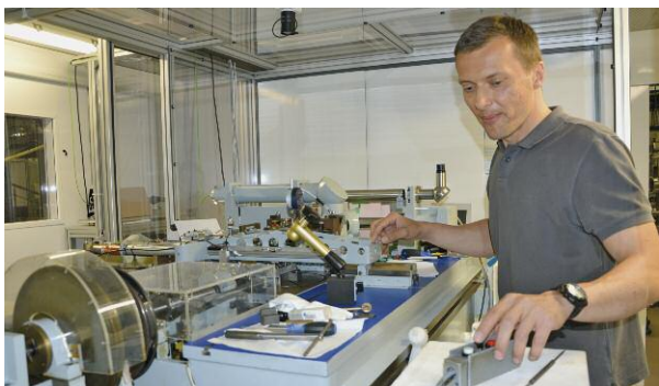
In diesem Gerät entstehen die Sägezahn-Strukturen. Ein Diamant ritzt dabei in die mit Gold beschichteten Silizium-Substrate kleinste Rillen.
