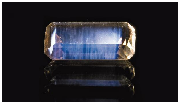
Bläuliche Sanidinvarietät. Die Kristalle weisen nach einiger Zeit Defekte auf, die sich durch Erwärmen heilen lassen. Was dabei genau vor sich geht, hat HZB-Doktorand Johannes Kähn untersucht.
