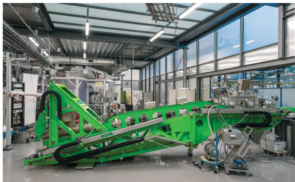
Der grüne Arm des neuen Instruments METRIX, das an BESSY II entsteht. Hier fliegen die Photonen von der Probe kommend zum Detektor.
