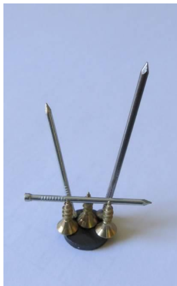
Der Magnet zieht alle Schrauben und Nägel an, weil sie ferromagnetisch sind
